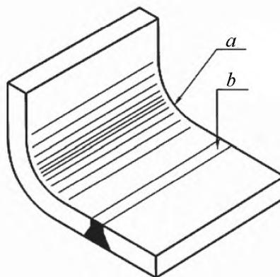
Возможность очистки улучшается при  $R = 20$  мм
