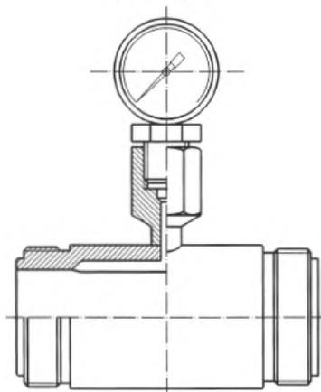
Рисунок А.20 – Приборы (манометры)
