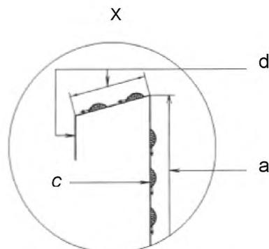
*a* – зона, контактирующая с пищевыми продуктами (отложенный пищевой продукт может вернуться в основную массу пищевого продукта); *c* – зона, не контактирующая с пищевыми продуктами; *d* – зона разбрызгивания (отложенный пищевой продукт не может вернуться в основную массу пищевого продукта)
