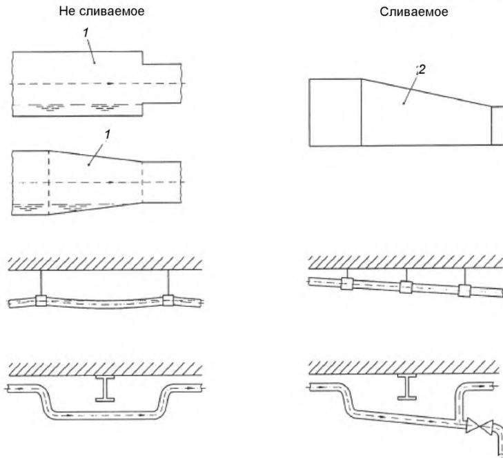
1 – концентричный переходник; 2 – эксцентричный переходник
