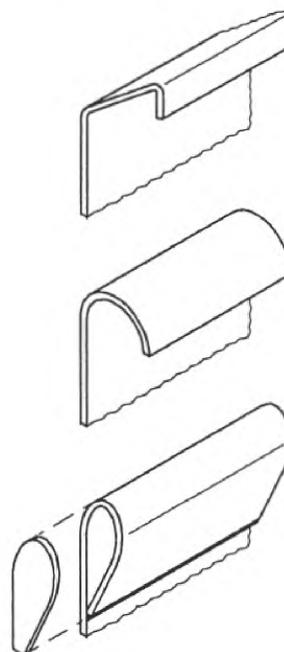
Хотя все представленные конструкции верхнего края способствуют приданию конструкции жесткости, они имеют отбортовки, на которых могут скапливаться остатки пищевого продукта, которые трудно очистить
