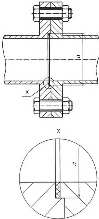
Степень сжатия уплотнения ограничивается конструкцией фланца
