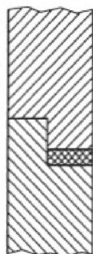
При сжатии на 15 % твердость резиновых прокладок по Шору 70 единиц обеспечит непроницаемое для бактерий соединение. Важно ограничить сжатие, чтобы предотвратить повреждение структуры прокладок, которое может привести к потере контактного давления
