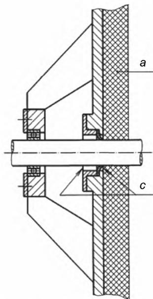
*a* – пищевой продукт; *b* – пищевой продукт может попасть в подшипник; смазка может загрязнить пищевой продукт; *c* – уплотнение, очищаемое с обеих сторон
