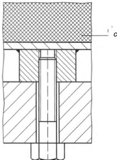
*a* – незащищенная резьба, надрывы и/или соприкосновение металлических поверхностей нелегко очищать, и они будут являться источниками инфекции; *b* – промежуток между резьбовой частью и отверстием не очищается; *c* – зона, контактирующая с пищевыми продуктами; 1 – винт с головкой с шестигранным углублением под ключ
