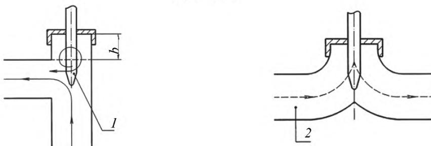
*a* – мертвая зона, где задерживается воздух и образуется конденсат; *b* – короткозамкнутый отрезок; 1 – датчик; 2 – изогнутый тройник
