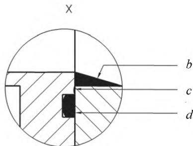
*a* – несоосность; *b* – области, которые могут накапливать пищевой продукт и очистка которых затруднена; *c* – соединение металлических поверхностей, через которое могут проникать бактерии; *d* – уплотнение, которое представляет собой не очищаемую зону
