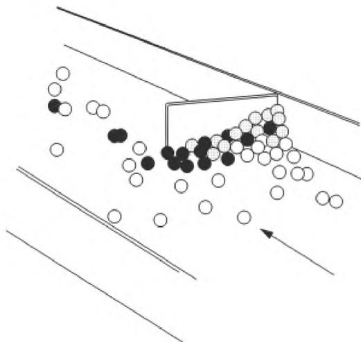
На рисунке показано, как пищевой продукт на конвейере, который задерживается противотоком, ухудшается и теряет цвет, но впоследствии может быть вытолкнут в основной поток пищевого продукта свежим материалом. Этого следует избегать
